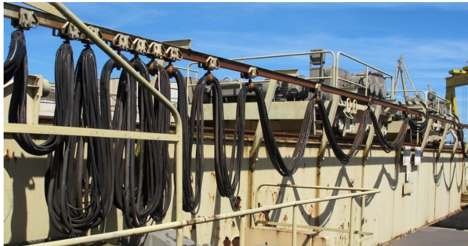
Rysunek 13. Starzenie izolacji przewodów oponowych zasilania wciągarki suwnicy pracującej na wolnym powietrzu.
