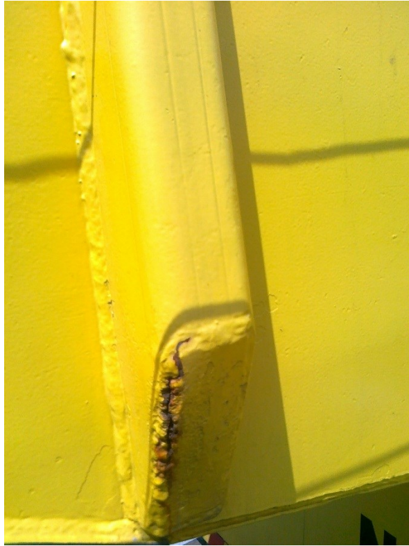
Rysunek 11. Pęknięcie czlonu wysięgnika.
