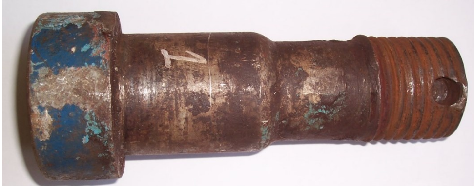
Rysunek 2. Śruba zawieszenia wciągnika z zaawansowaną korozją gwintu.
