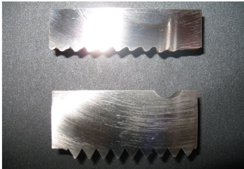
Rysunek 3. Porównanie przekrojów gwintu nowego i skorodowanego.
