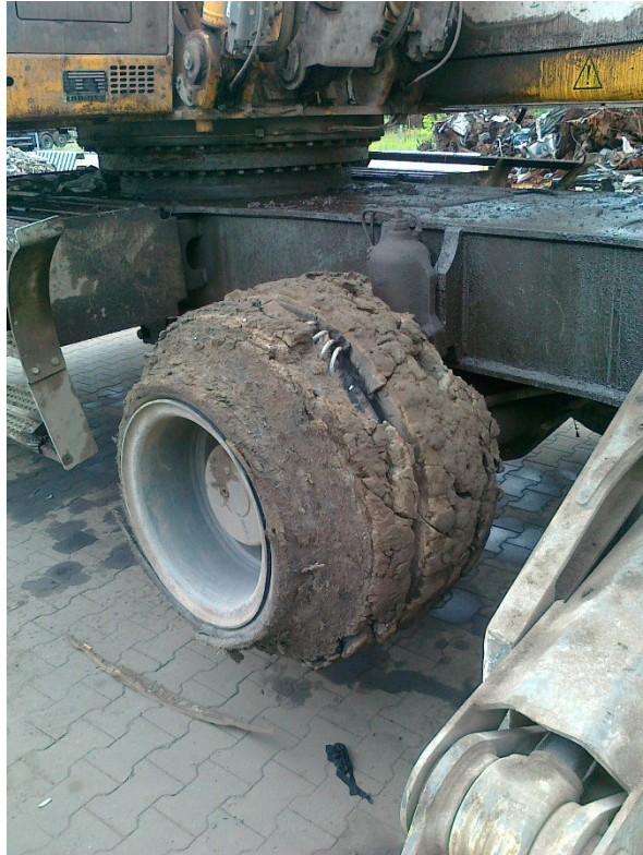
Rysunek 7. Ponadnormatywne zużycie koła jezdnego żurawia samojezdnego.
