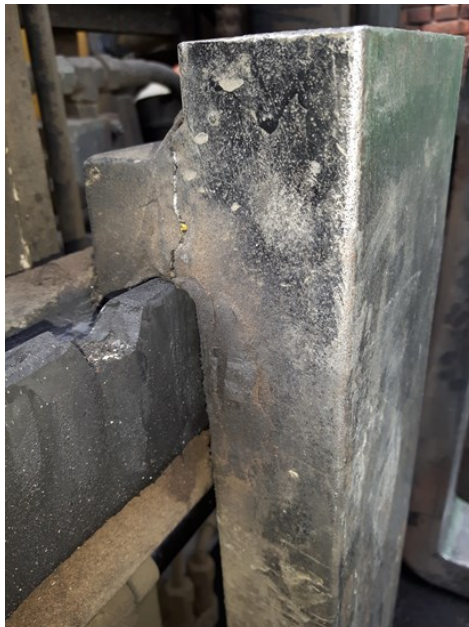
Rysunek 16. Pęknięcie widły wózka jezdniowego podnośnikowego.
